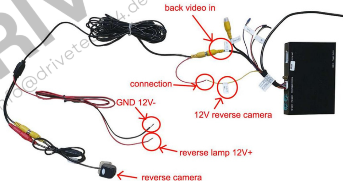
Kabelanschluss für Aftermarket-Rückfahrkamera
